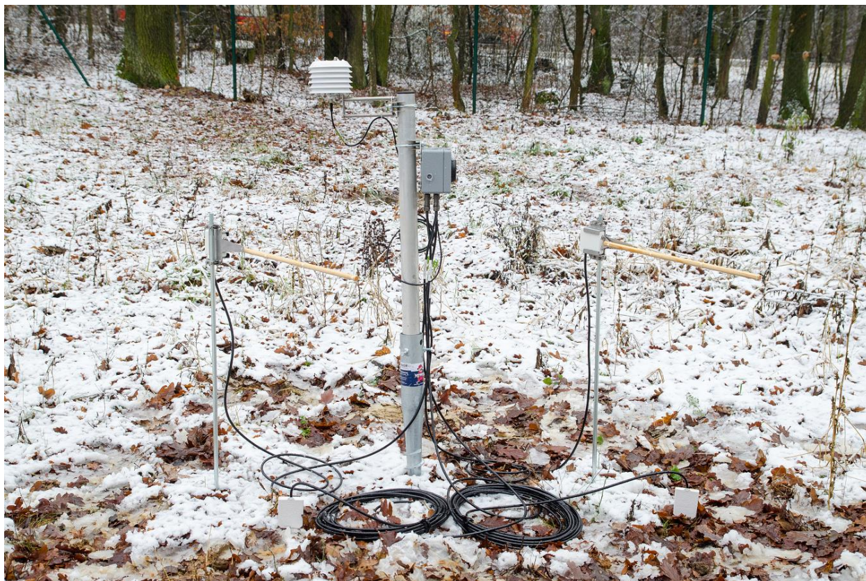
Obr. 3.1: Systém pro měření požárně rizikových podmínek. Systém sestává ze 2 senzorů na měření půdní vlhkosti, dvou senzorů na měření vlhkosti dřeva a kombinovaného senzoru na měření teploty a relativní vlhkosti vzduchu, respektive sytostního doplnku. Tyto systémy budou nově doplněny i o tzv. dendrometry, t.j. senzory pro měření přírůstu i vodního stresu žijících stromů.
