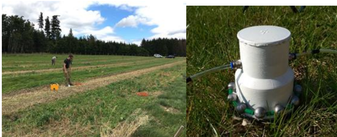
Obr. 4.7: Měření půdní respirace v experimentech zaměřených na podporu ukládání uhlíku v půdě (přodochranné technologie zpracování půdy, setí do mulče zbytků meziplodiny, aplikace biouhlu apod.).
