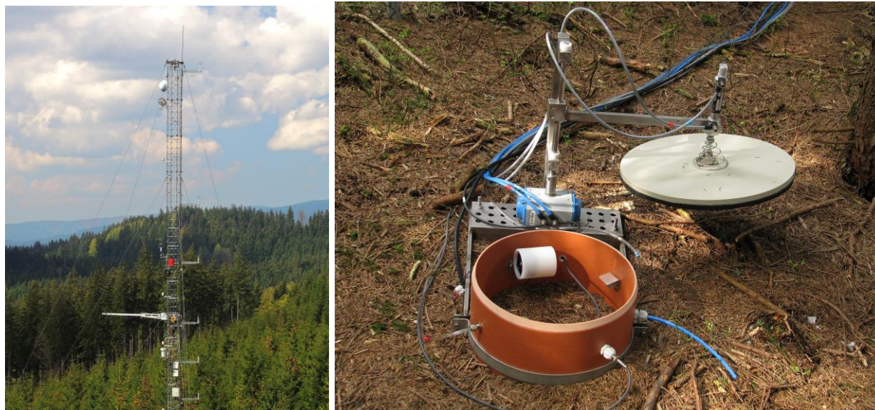
Obr. 4.5: Meteorologický stožár s eddy-kovariačním systémem pro měření uhlíkové výměny mezi porostem a atmosférou (ekosystémová stanice Bílý Kříž, Beskydy); komora pro měření půdní respirace (automatický systém SAMTOC-II, ÚVGVZ & KONEL, ČR).
