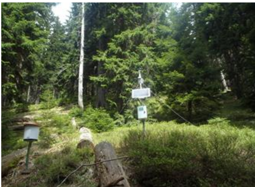
Obr. 4.8: Mikroklimatická stanice v horském lese pro měření stresových parametrů lesních porostů.
